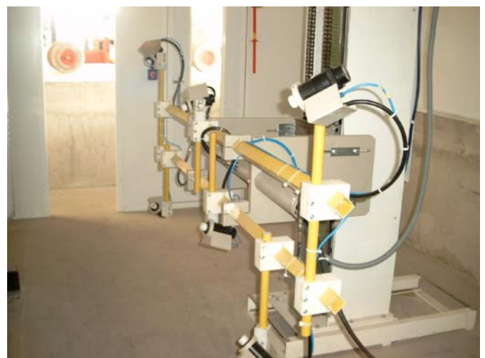
Hubgerät mit isoliertem Sprühsystemaufbau und reproduzierbarer Sprühsystem-Halterung.
