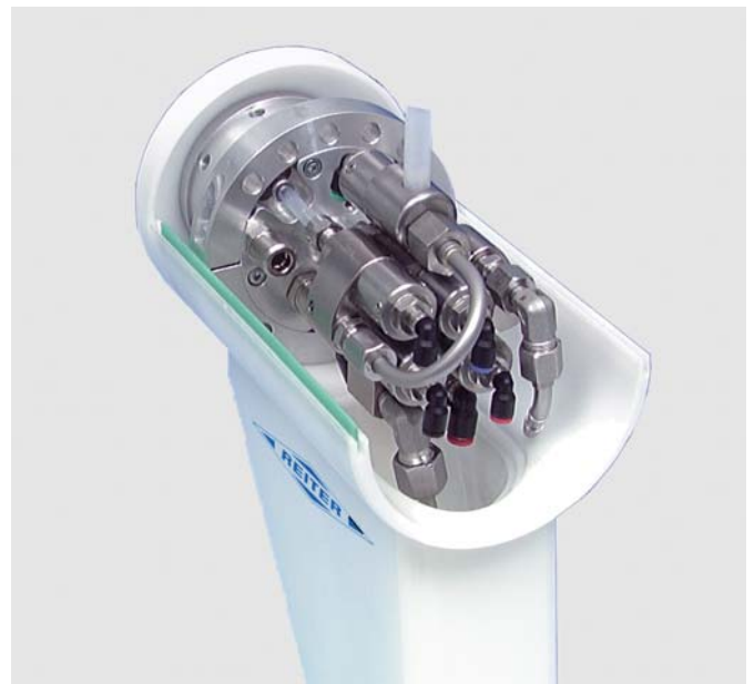
Material- und Steuerleitungen werden durch den Roboterarm und den Halter zu den Anschlüssen des Zerstäubers geführt.
