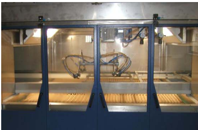
Flächenspritzer mit 2-Etagen-Umlufttrockner und Lüftungstechnik
