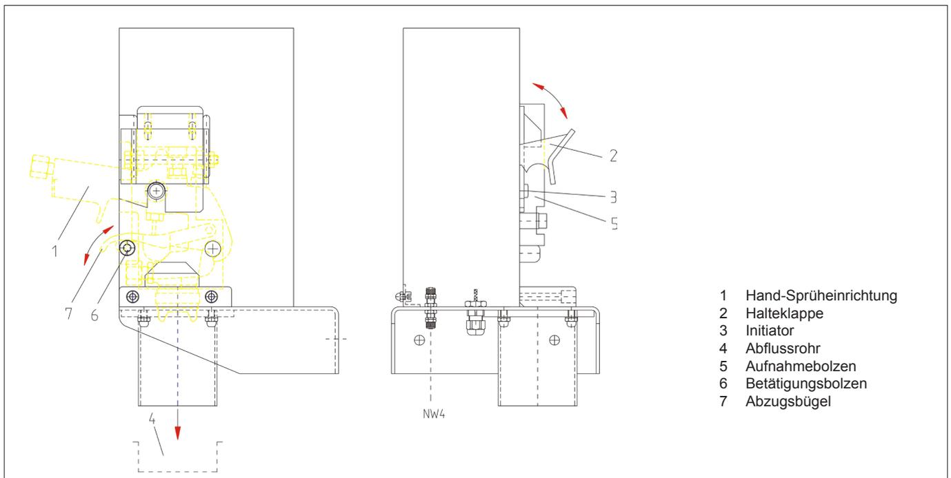
Die Pistolen-Abziehvorrichtung ist eine Positioniereinrichtung für Handsprühsystem, welche bei Spülung bzw. Farbwechsel sowie in Arbeitspausen verwendet wird.
