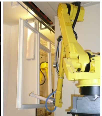
Lackieren nach generiertem Programm
