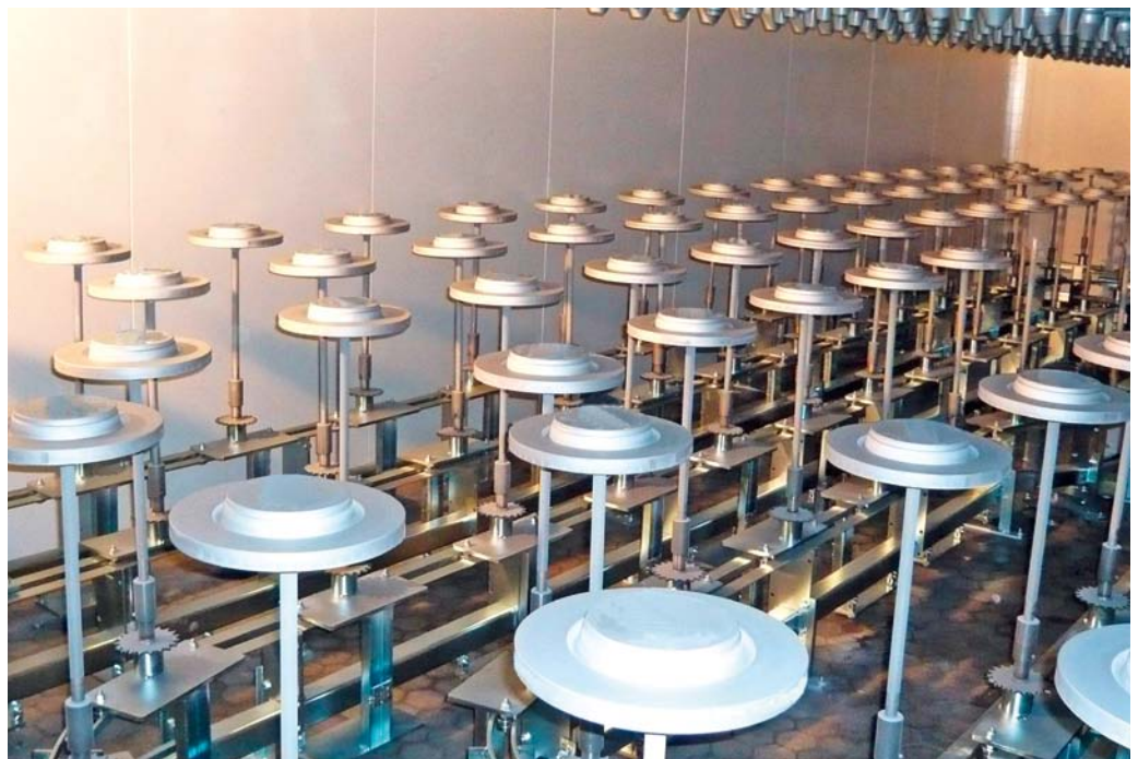
Der Duplex-Bodenförderer schleust die Werkstücke durch den Trockner.
