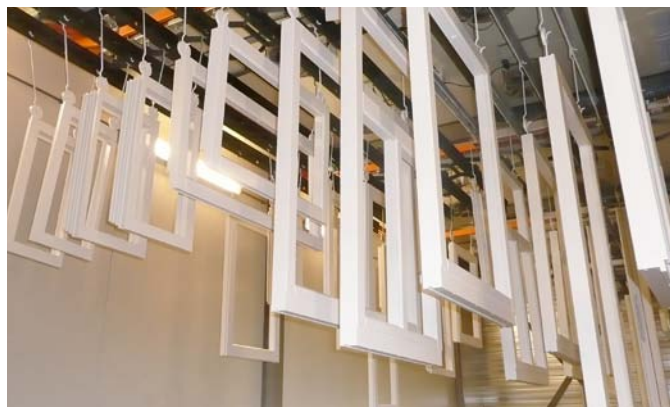
Mit der neuen Anlage können bis zu 30 Fensterrahmen pro Stunde beschichtet werden.
