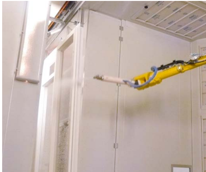
Beim Lackieren mit einer Air-Assisted-Roboterpistole sorgt eine verbesserte Spritzdüse für eine gleichmäßige Zerstäubung und ein sehr gutes Finish.
