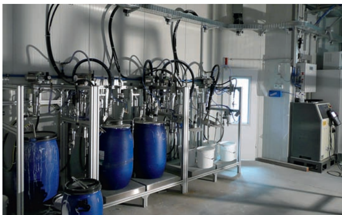
Das System ist auch fit für kleine Chargen und schnelle Farbwechsel. Hier im Bild: Versorgung für vier Farben und Spülmittel (Bildnachweis: Reiter)
