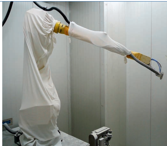
... Fanuc-Roboter und luftunterstützter Automatik-Spritzpistole
