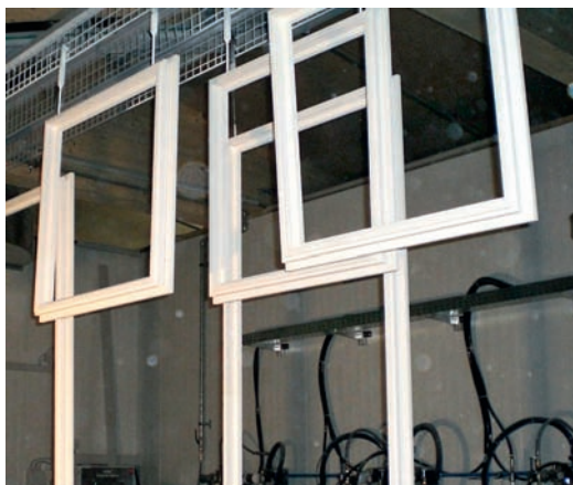
Aufgehängte Fensterelemente im Pufferbereich vor dem automatischen Scannen
