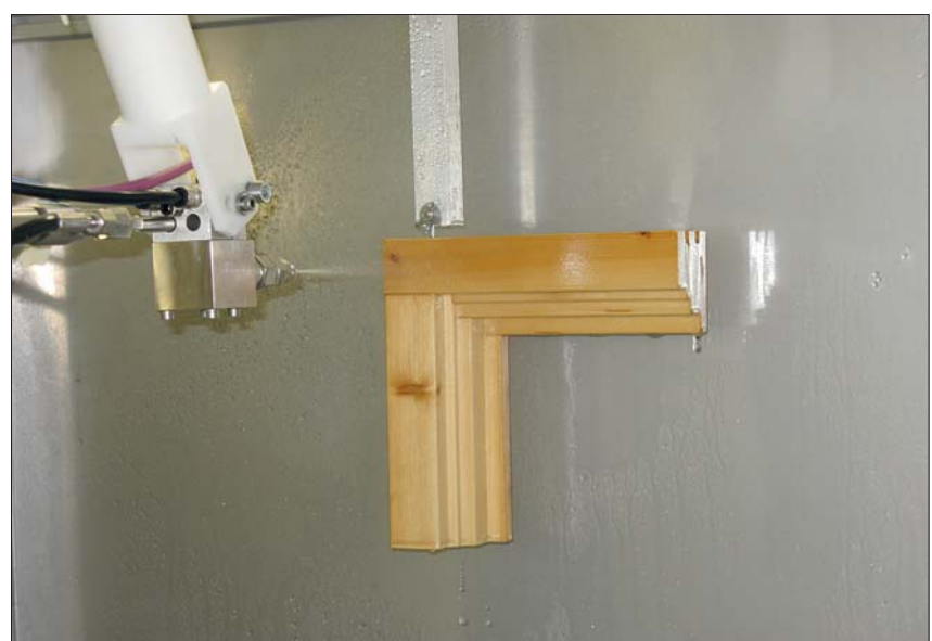
Abbildung 2 Fensterecke aus Fichtenholz, mit einer Flachstrahl Düse (Quelle: Firma Lechler) geflutet
